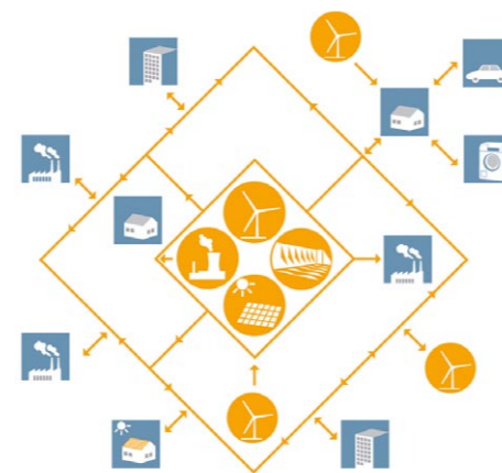
Zentrale und dezentrale Erzeugung mit Lastfluss in verschiedene Richtungen © ABB
